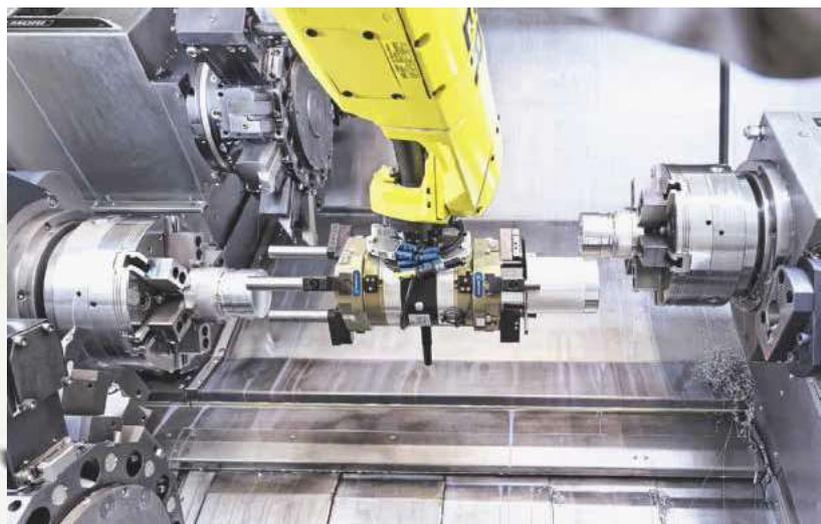
*Das 6-Backen-Kraftspannfutter Rota NCR ermöglicht eine schonende und präzise Spannung deformationsempfindlicher Bauteile. Bild: Schunk*
