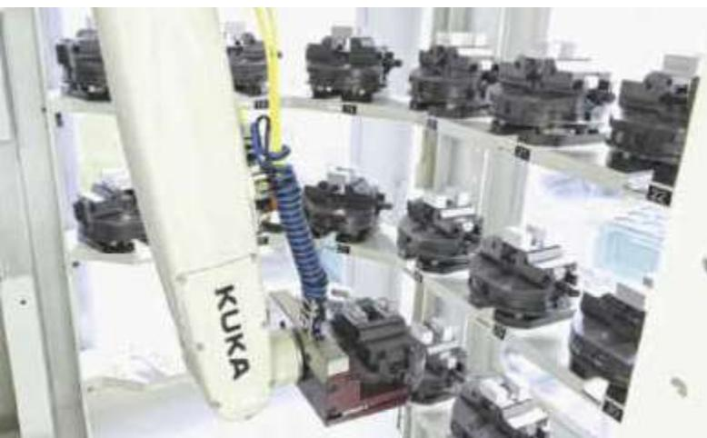
*Das Werkstückmagazin dieses 5-Achs-Bearbeitungszentrums ist mit 39 Kontec-KSC-Basisspannern zur Kleinteilfertigung ausgestattet. Die Spanner werden hauptzeitparallel gerüstet und per Roboter auf das Nullpunktspannsystem der Maschine eingewechselt.*
