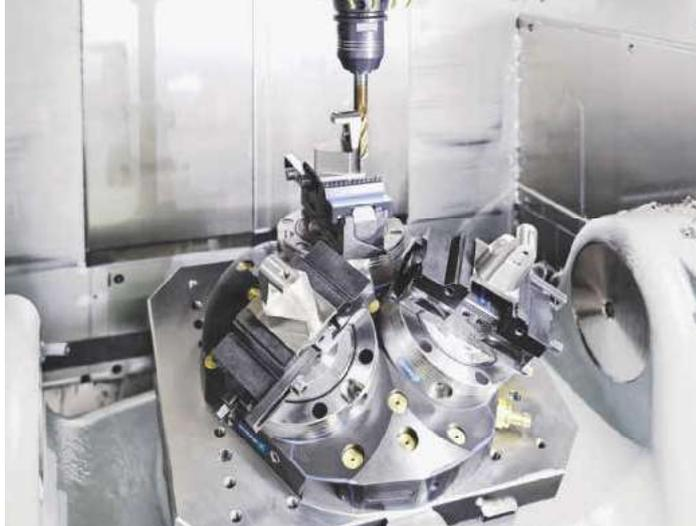
*Kontec-KSC-Basisspanner werden mit wenigen Handgriffen auf den Vero-S Schnellwechsellmodulen der Spannpyramide gespannt. Bild: Schunk*
